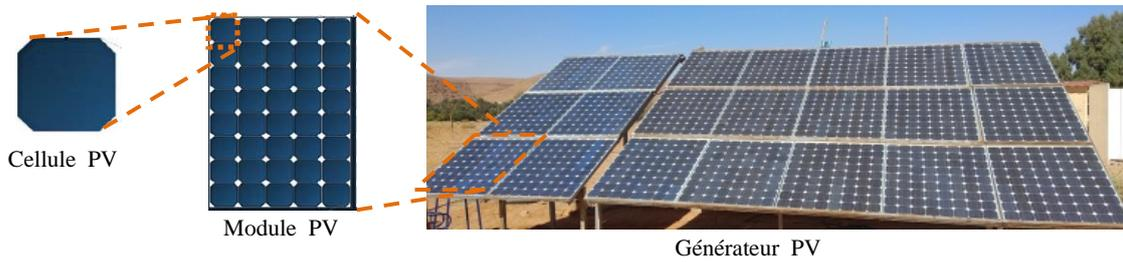
Figure I.2 Construction de base d'un générateur PV.
