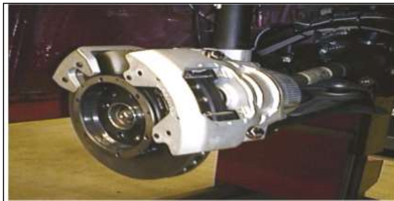
Figure I. 12. Système de freinage électromécanique EMB [40]
