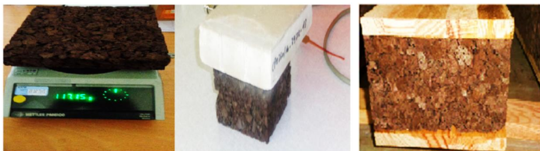
Figure III.10 Spécimen de liège testé (à gauche), configuration du sandwich examiné (à droite) [10].
