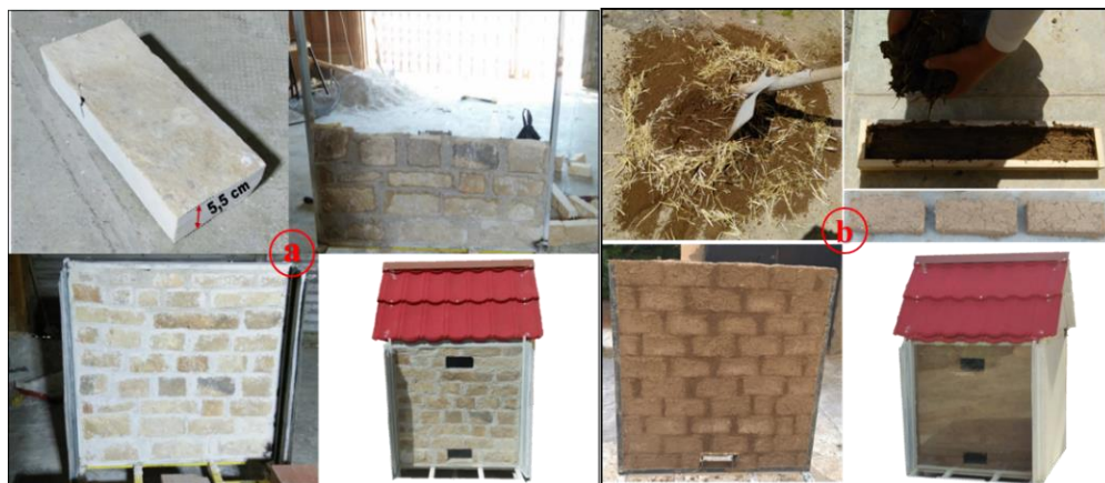
Figure IV.12 Matériaux à inertie thermique utilisés pour la construction du mur de la façade : a: Pierres taillées, b: Adobe.
