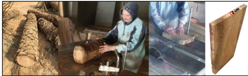
Figure IV.1 Etapes de préparation de l'échantillon du bois de palmier-dattier.
