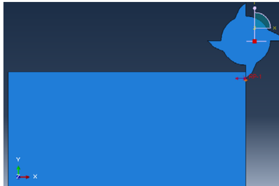
Figure (V-2) Exemple du fraisage périphérique à 4 flûtes
