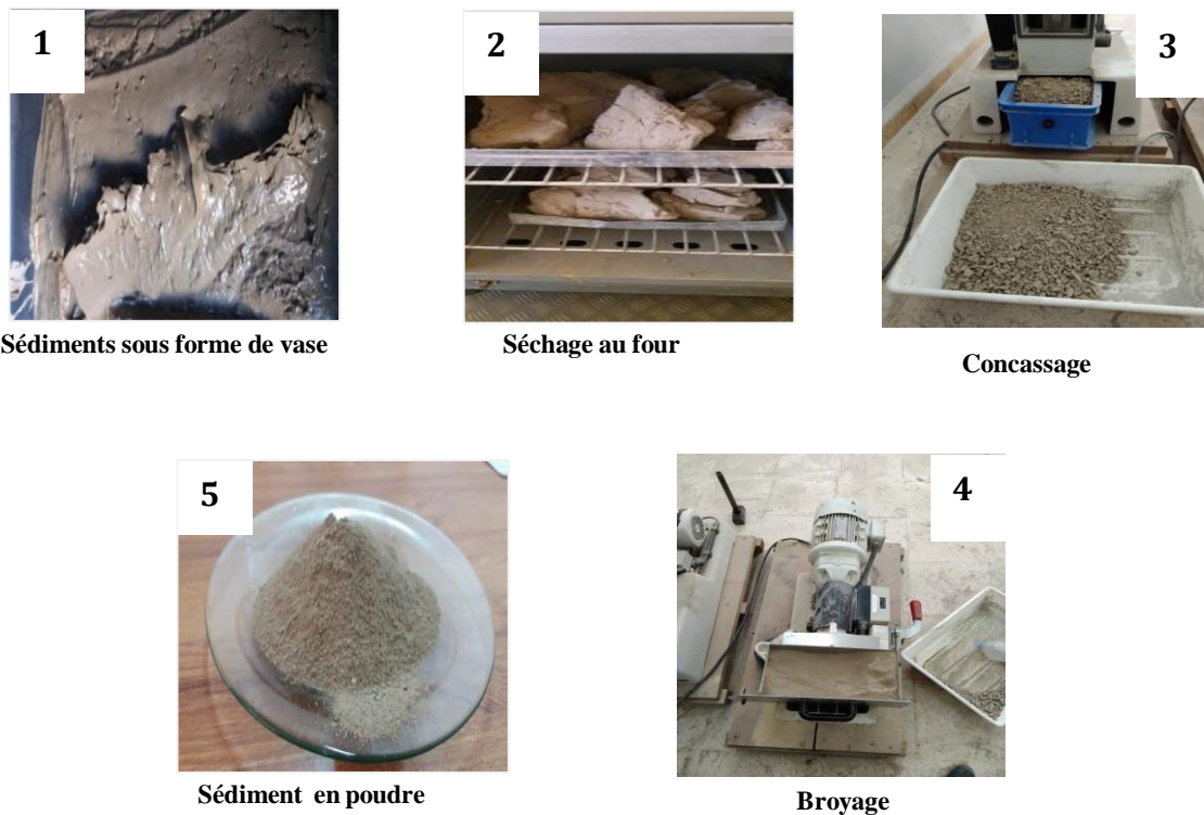
Figure 4.7 Opérations de séchage et broyage des sédiments
