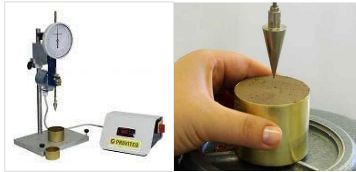
Figures 3.15 Cône de pénétration pour la détermination de WL.
