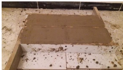
Figure 4.24. Moule utilisé 100 \times 200 \times 60 \text{ mm}^3
