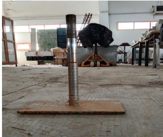
Figure 4.25. Dame adapté au moule pour compactage
