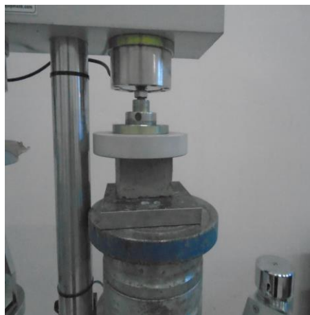
Figure 4.29. Image de l'écrasement de la brique en BTC (compression)
