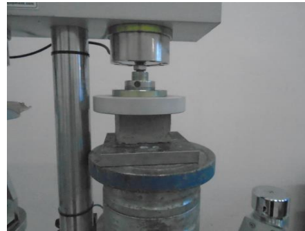
Figure 4.27 Schéma du principe de l'essai de compression
