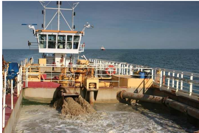
Figure 2.12. Refoulement de matériaux dragués dans le puits d'une drague
