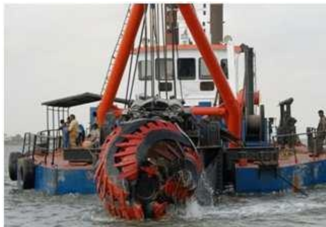
Figure 2.13 : Drague hydraulique à tête désagrégatrice
