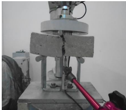
Figure 4.40. Image de l'écrasement de la brique en BTC (Flexion)
