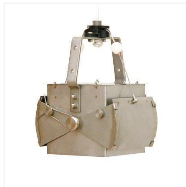
Figure 4.4 Bennes de type Eckman (à gauche) et Van Veen (à droite)
