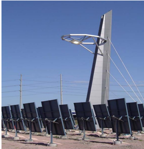
Figure 1.19. Entraînement linéaire pour l'héliostat de CSIRO [42].
