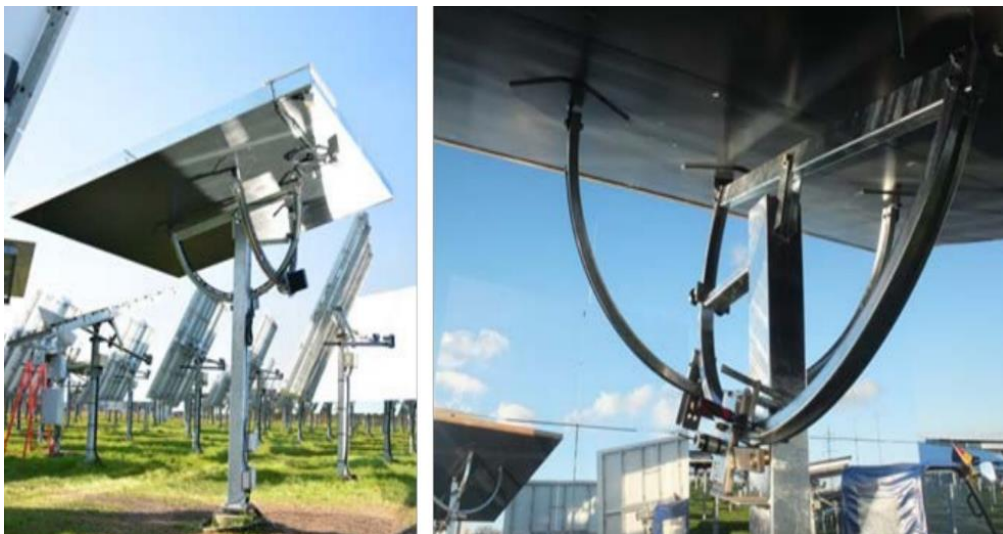
Figure 1.23. Actionneurs de jante de l'héliostat DLR [34].
