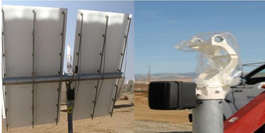
Figure 1.17. Gauche : héliostat LH 2.2 de BrightSource ; Droite : support de palier [1417, 3336].
