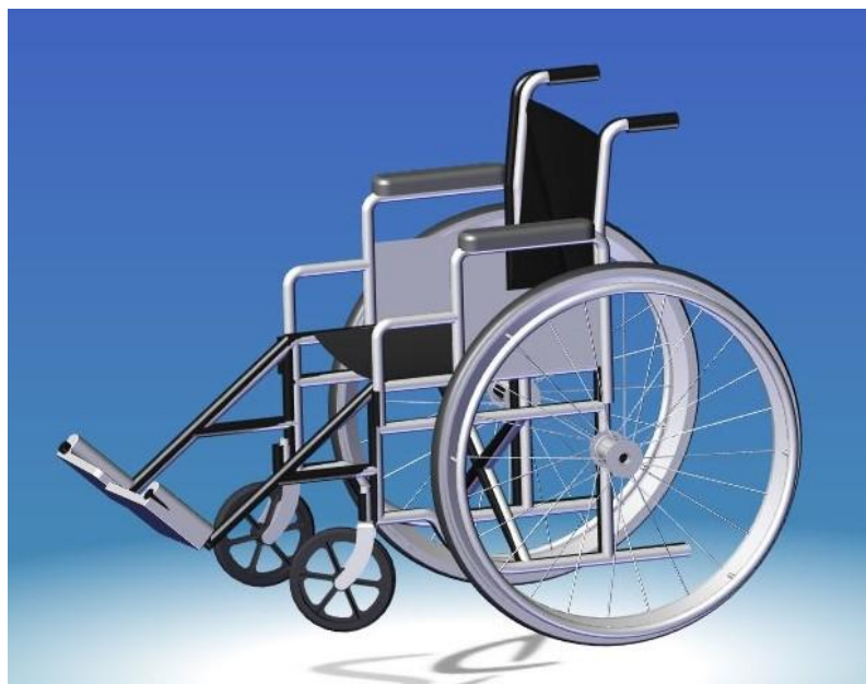
FIGURE 5.8 – Assemblage final du FRM modélisé
