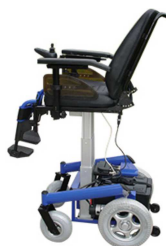
FIGURE 1.7 – FRE avec levage mécanique
