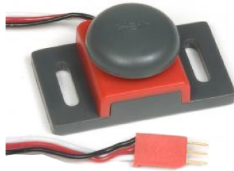
FIGURE 1.18 – Capteur de contact, type « Bumper ».
