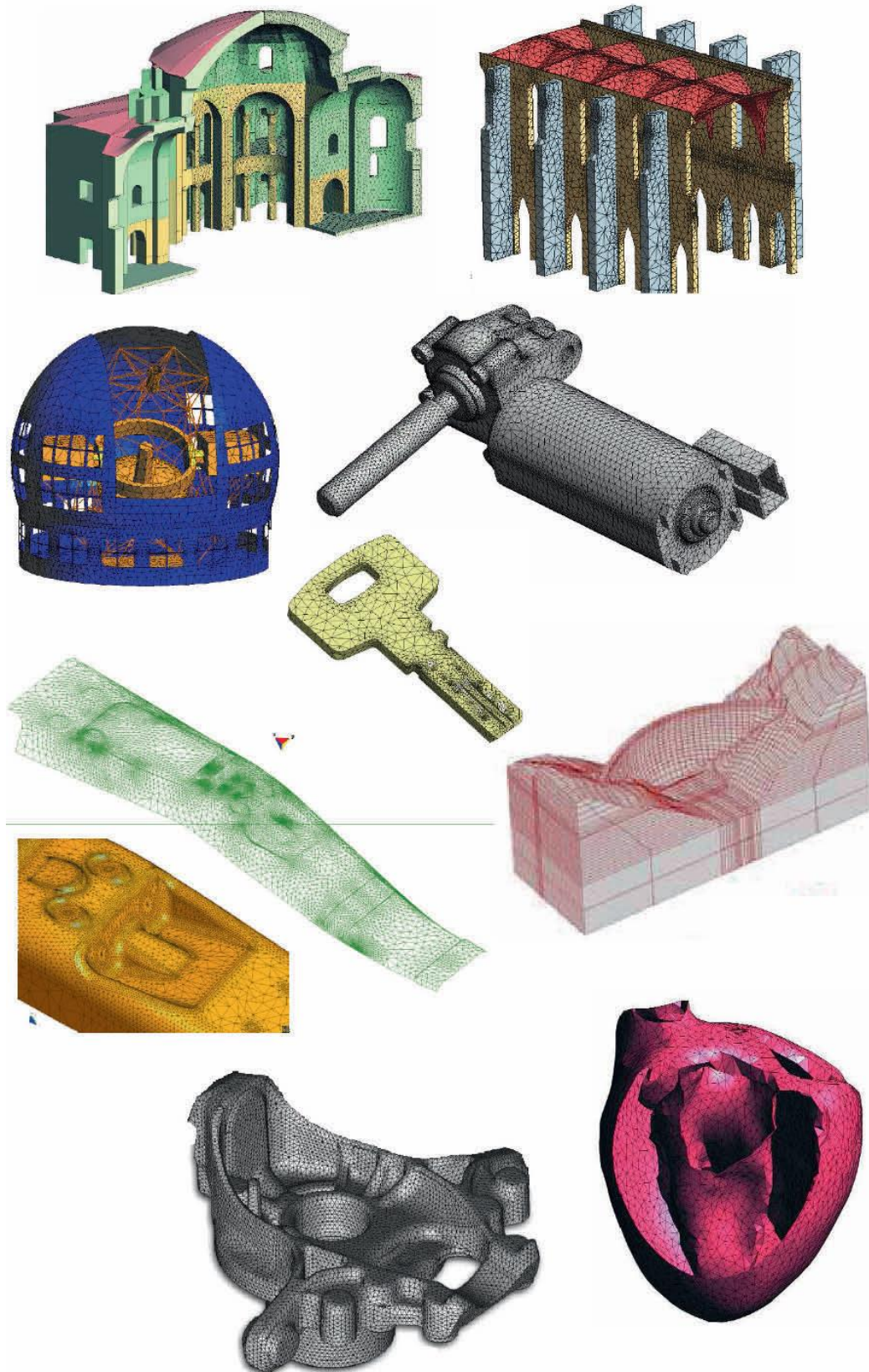
Figure 4.1 : Discretisation de différents solides et structures avec les éléments finis [OÑA, 2009].
