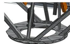
Figure 4.12: Maillage 3D du système MS-2 TRACKER 10+ par éléments finis 3D.
