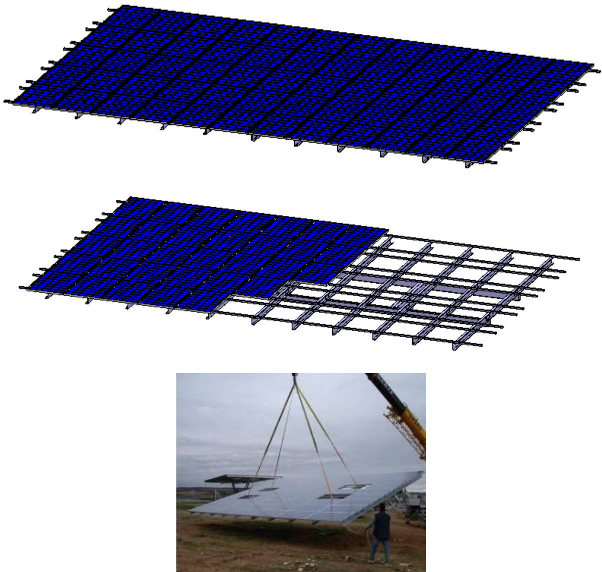
Figure 3.14 : La partie supérieure et la grille métallique du système MS-2 TRACKER 10+.
