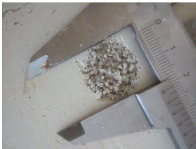
Figure 4.14. Mesure du diamètre de la colonne après chargement
