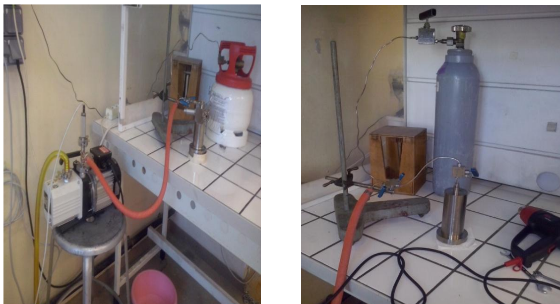
Figure 3.11. Chargement du mélange : R1234yf et R23.
