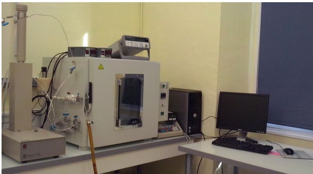
Figure 3.9. Photo de l'installation "dynamique-synthétique".
