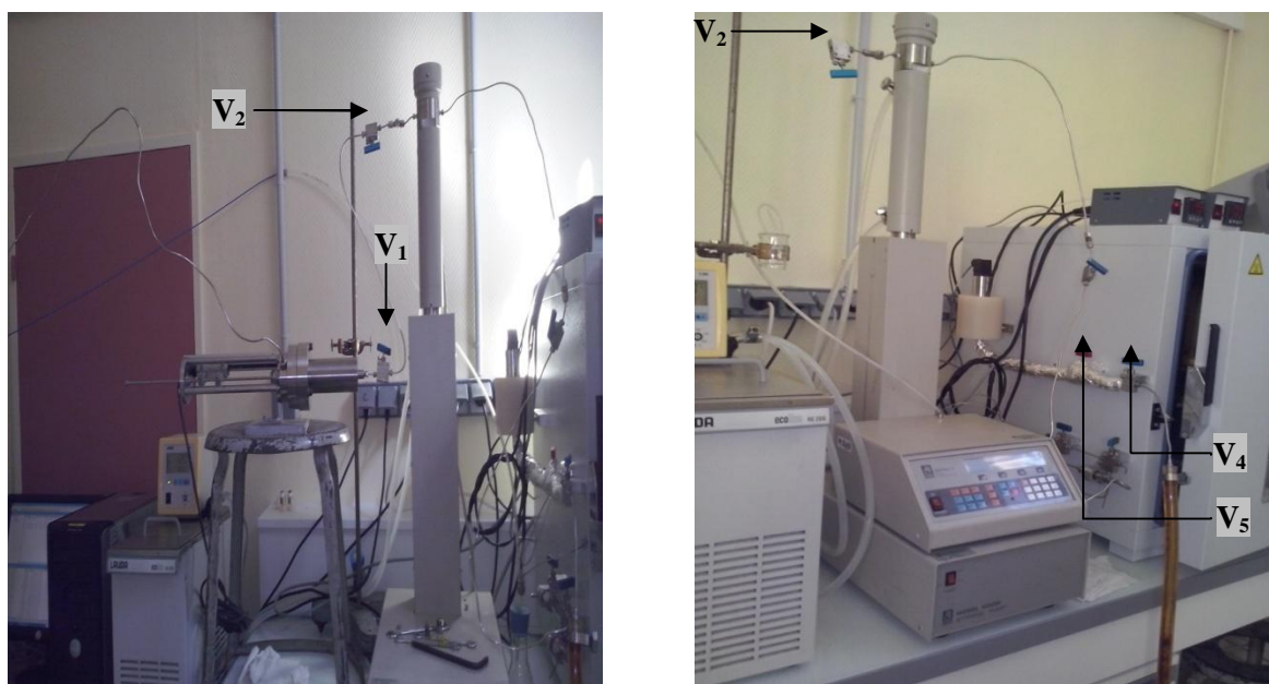
Figure 3.12. Transfert du mélange à partir de la presse volumétrique vers la pompe syringe.
