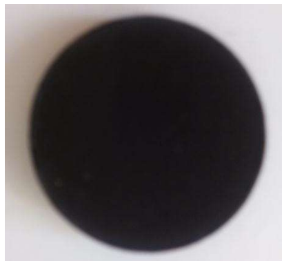
Figure 3.12: Pastille de CIGS obtenue après compactage
