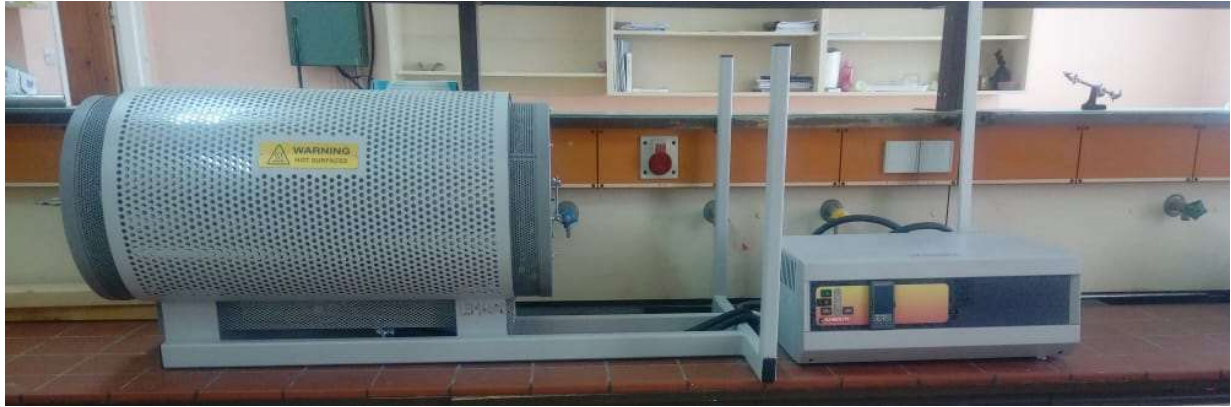
Figure 3.10 : Four pour la synthèse du matériau massif \text{CuIn}_{0,7}\text{Ga}_{0,3}\text{Se}_2 .
