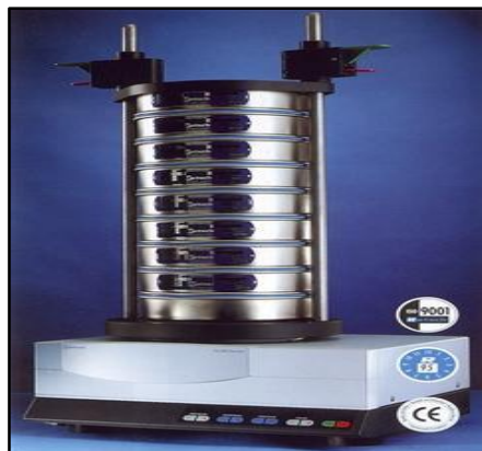
Figure n°10: Agitateur mécanique avec séries de tamis (Clement et Françoise, 1997).
