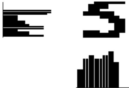
Figure 4.12 : Histogramme de projection horizontale et verticale du chiffre "5"
