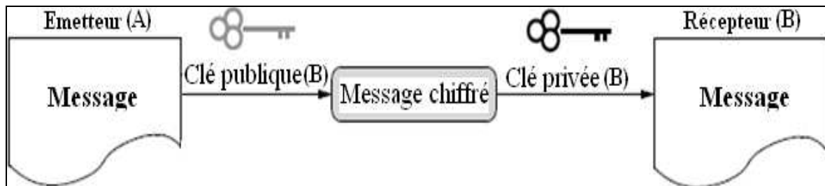
Figure 11 : Le chiffrement asymétrique. [33]
