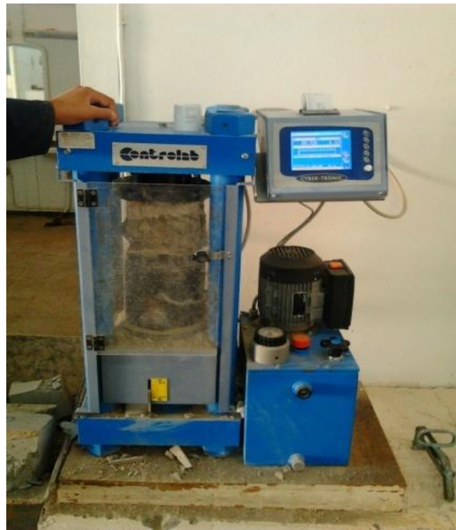
Figure II.18. Appareil d'essai de la résistance à la compression (Controlab).
