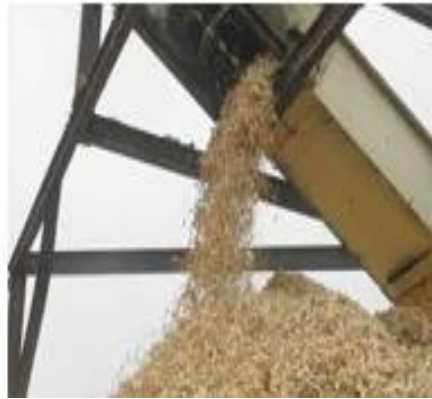
Figure II.2. Procédé du broyage du bois de palmier dattier (EPTR de Batna).
