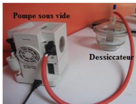
Figure II.14. Opération de mise sous vide de l'échantillon dans le dessiccateur.
