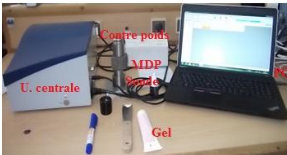
Figure II.17. Dispositif de mesure de la conductivité thermique (C-THERM), Model TCi-3-A.
