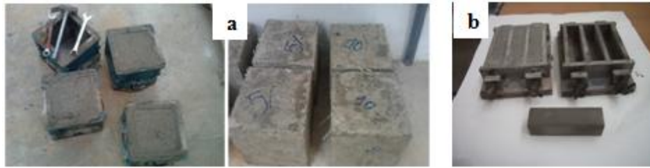
Figure II.8. Les éprouvettes et les moules ; a ( 150 \times 150 \times 150 ) \text{mm}^3 et b ( 40 \times 40 \times 160 ) \text{mm}^3 .
