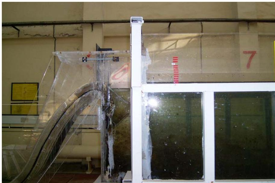
**Photo.3.7.** Réservoir surélevé gradué (Retenue)
