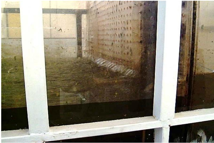
**Photo.3.8.** Plaque perforée d'atténuation de la turbulence incidente
