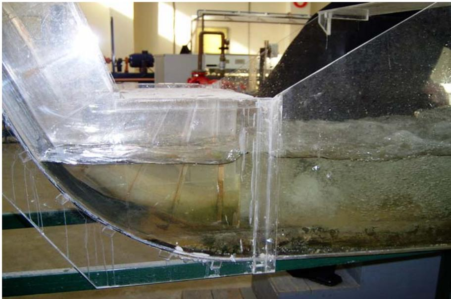
**Photo.3.9.** Bassin convergent pour l'amorçage du siphon
