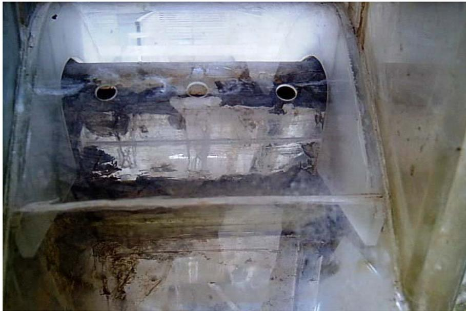
**Photo.3.3.** Entrée du siphon et orifices d'aération
