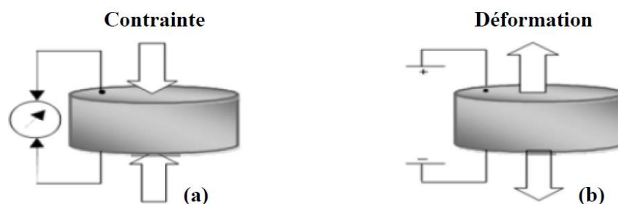
Figure I.5:L'effet piézoélectrique : (a) effet direct, (b) effet inverse
