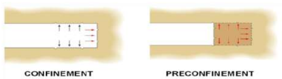
Fig. I.45 : Action de confinement et de préconfinement [(Lunardi, 2008)].
