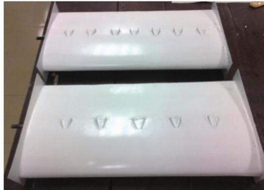
Figure I.5 Aile composite en fibre de verre avec différentes VGs.
