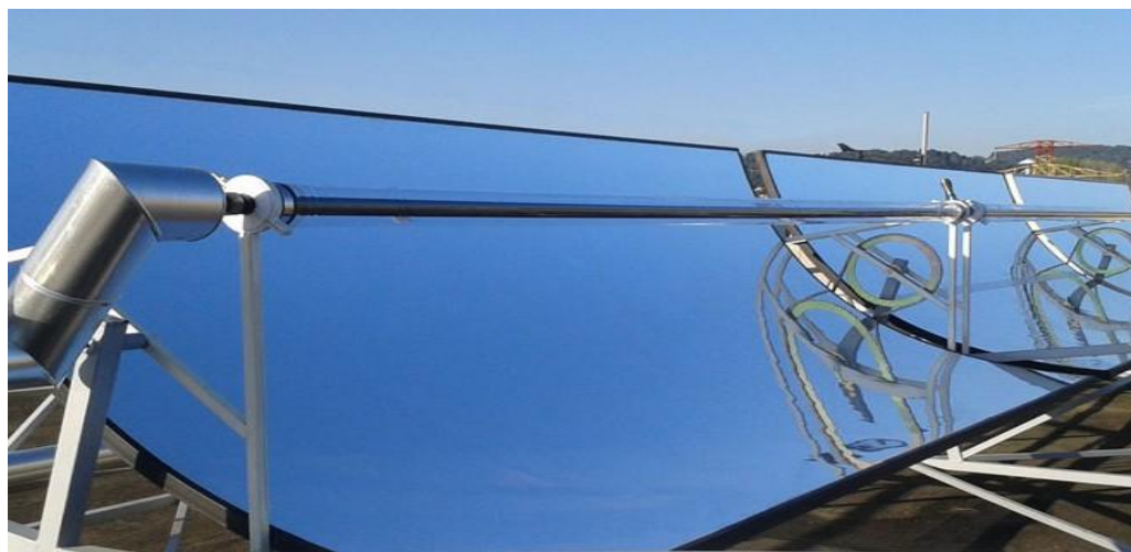
Figure 1.44 : Miroir cylindro parabolique [75]
