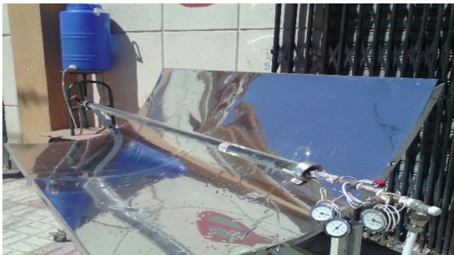
Figure 4.6: Capteur solaire cylindro-parabolique avec le miroir S-Reflect
