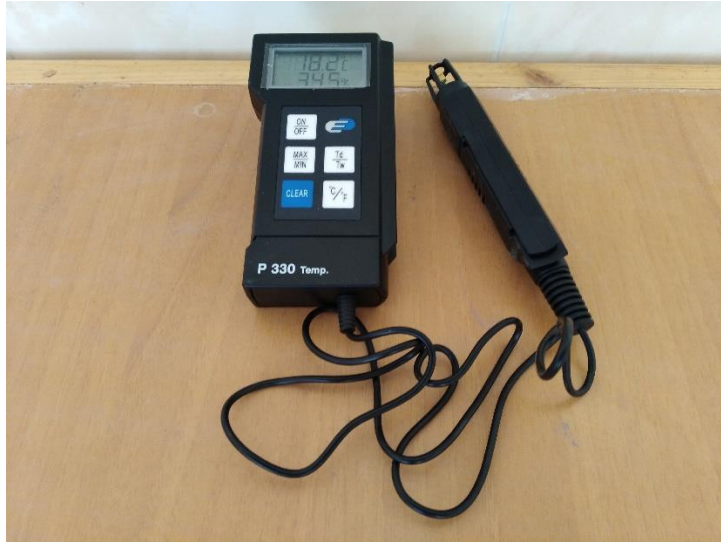
Figure. 6-16. Humidimètre à sonde pour la mesure de l'humidité relative et de la température des solutions salines saturées.
