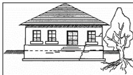
Figure. 1-7. Désordres partiels dus à la présence d'un arbre trop proche de l'angle du bâti (CEBTP, 1991).
