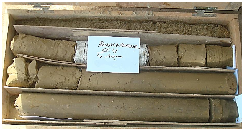
Figure 6-8. Matériau intact (non remanié) sous forme des carottes.
