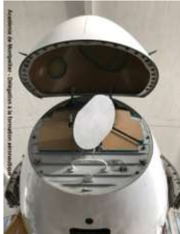
Figure 1. 13. Radôme en forme de cône qui une fois soulevé montre le radar d'un Airbus A320 [27]
