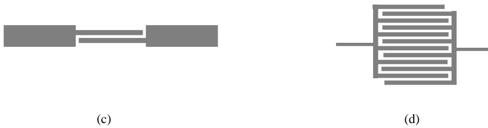
Figure 1. 5. Eléments semi-localisés : (a) inductance en spirale, (b) inductance en méandre, (c) capacité de découplage (d) capacité interdigitée [5]
