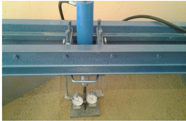
Figure III.5 Comparateurs de déplacement.
