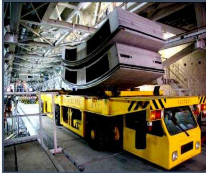
Figure 1.24 Transport de segments dans le tunnel.
