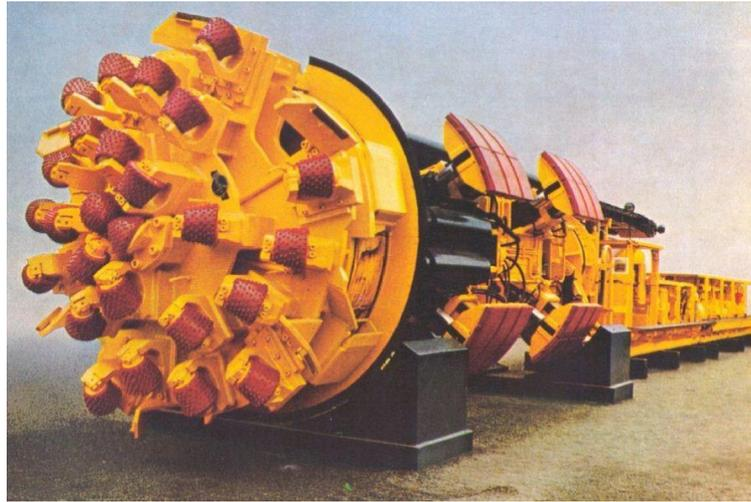
**Figure 1.12 Tunnelier à appui radial**
