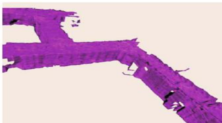
Figure 1.7 : Carte d'intérieur 3D à partir d'un plan vertical balayé LADAR.
