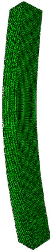
**Figure IV.15 :** Premier mode de flambement de la colonne
