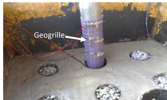
Figure I.15 Colonnes ballastées refermées par geogridle
