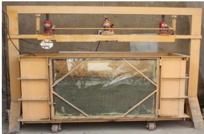
Figure I.13 Conteneur de test expérimental et système de chargement (Fattah et al. 2016)
