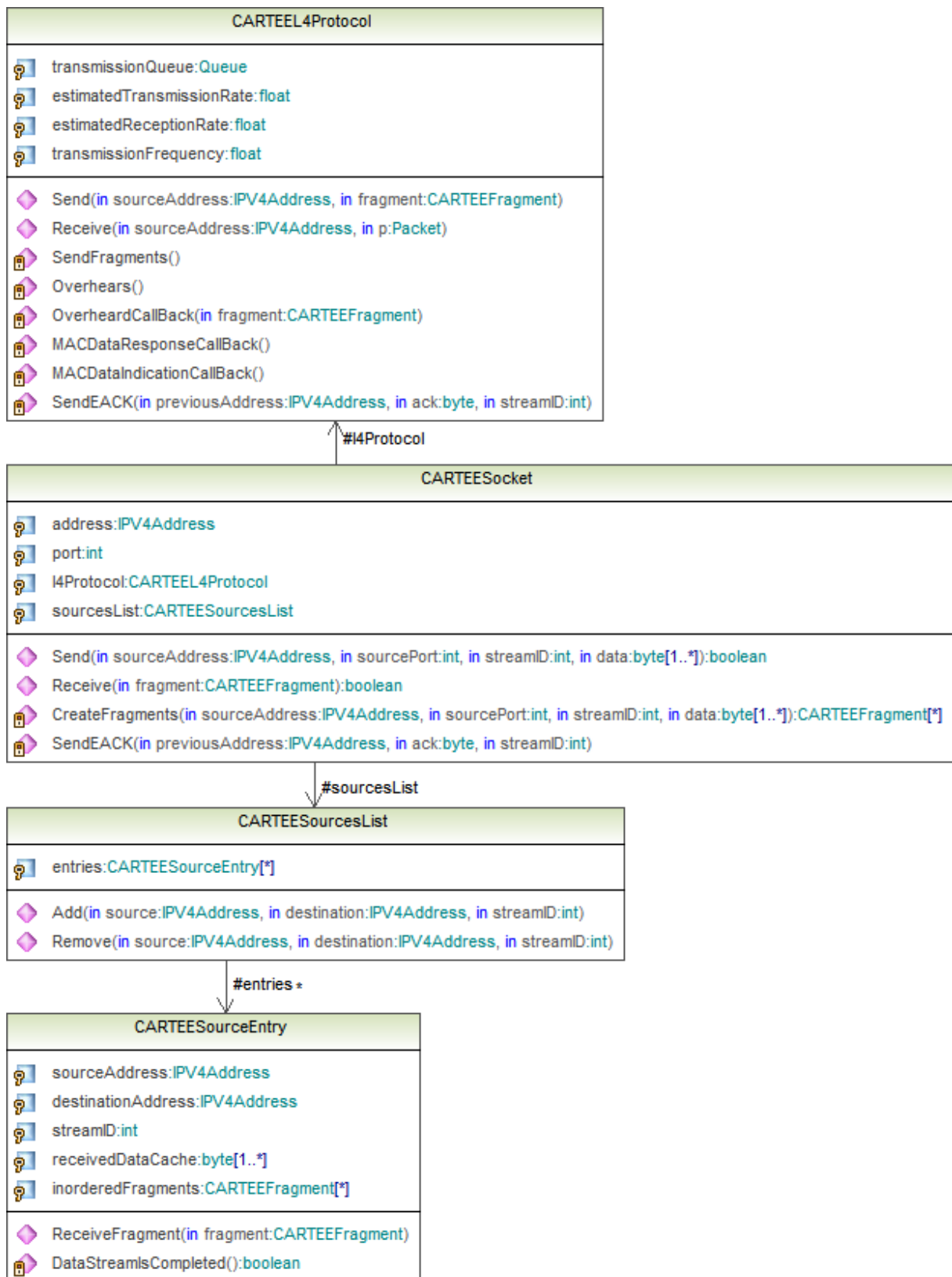
FIGURE 4.4 : Diagramme de classe du modèle CARTEE implémenté sous ns-3
