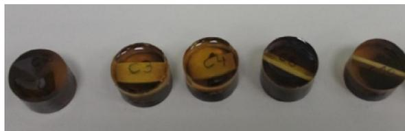
**Figure III.28. Echantillons imprégnés dans une résine.**
