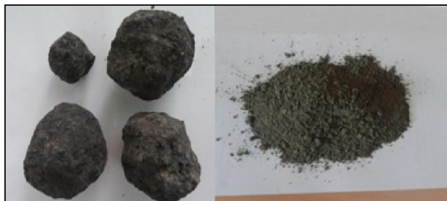
Figure III.1. Image d'un échantillon du clinker d'Ain-El-Kébira
