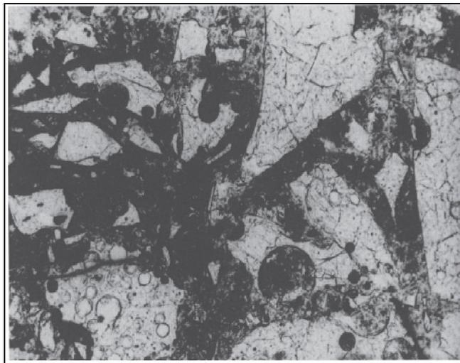
Figure II.16. Particules de laitier vitreux (en blanc). Notez la forme des particules de laitier et leur aspect poreux dû à la trempé dans l'eau. Les particules de laitier totalement vitrées indiquent que la température de ce laitier était élevée lorsqu'il est trempé (ce laitier est parfois appelé « laitier chaud ») (Aïtcin, 2004)
