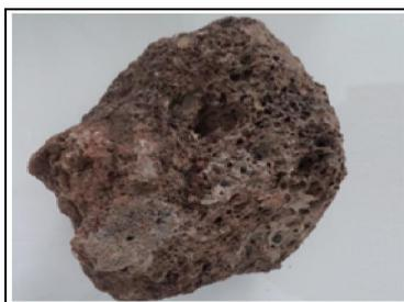
**Figure III.10. Echantillon de la roche de la pouzzolane utilisée.**
