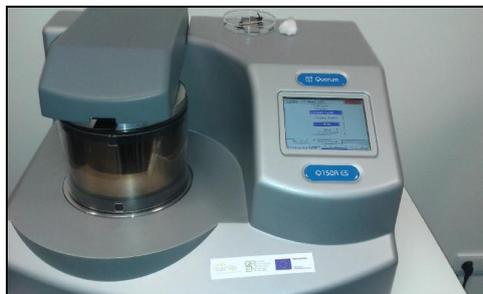
**Figure III.30. Appareil pour Revêtement des échantillons**
