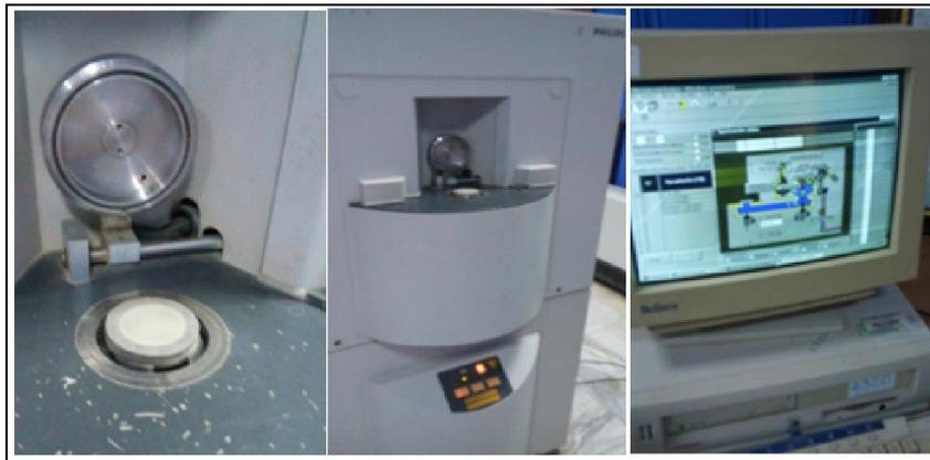
Figure III.19.Appareillage des analyses chimiques (Cimentrie d'Ain-El-Kébira)
