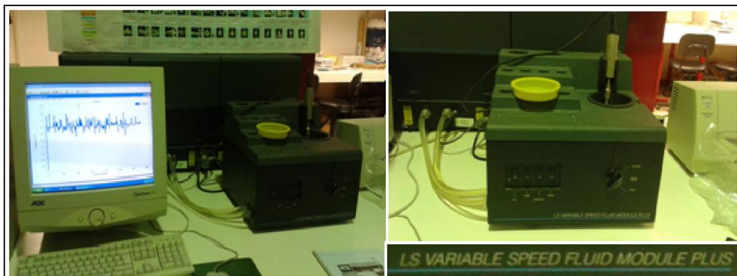
Figure III.20 Granulométrie laser (LS variable speed fluid module plus)
