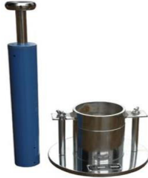
Figure 3.20 : Moule et dame de compactage de l'essai Proctor normal
