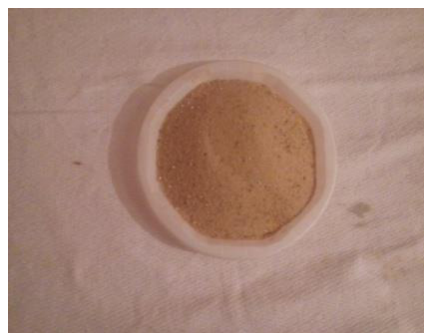
Figure 3.3: Echantillon de sable de Boussaâda (M'sila), tamisé à 2mm.
