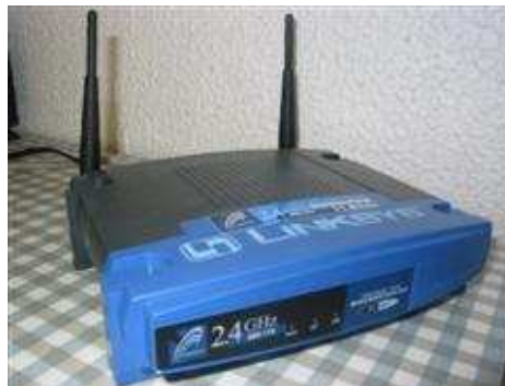
Figure 2.12 : Le Linksys Wap11 est un point d'accès IEEE 802.11b
