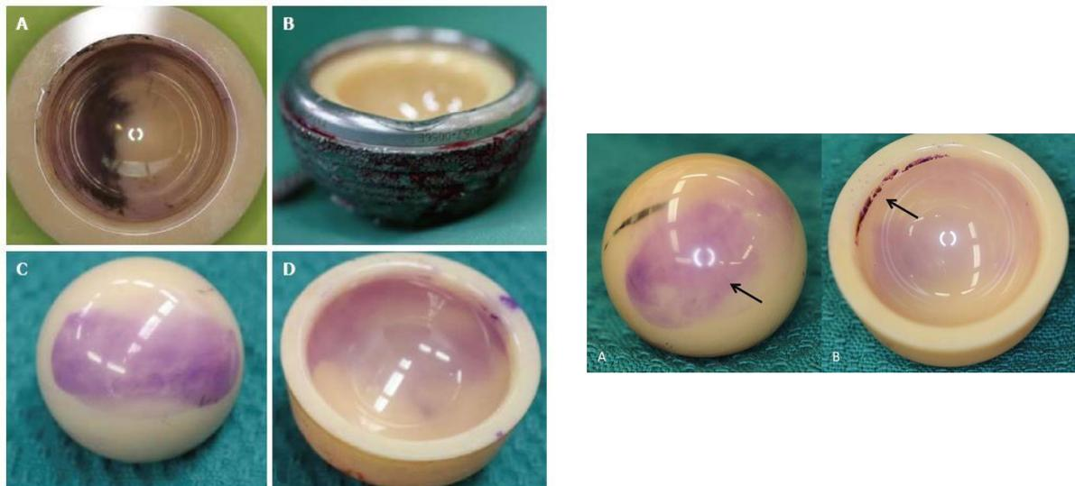
**Fig. I.14 :** Identification des bandes d'usure par un marquage violet sur la tête en céramique (A) et doublure (B) ; l'impact est identifié par une encoche créée sur la coque acétabulaire (C et D) [Levy YD. 2015]
