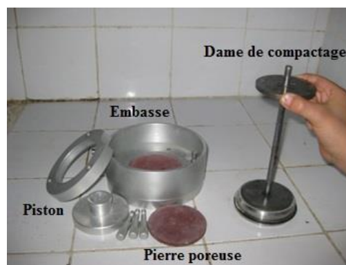
Figure III.13 : Moule œdométrique et dame de compactage
