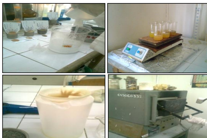
Figure III.22 : Phases de l'essai aux sulfates ( \text{SO}_4^{2-} )
