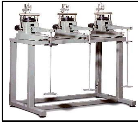
Figure III.14 : Schéma d'ensemble de l'œdomètre
