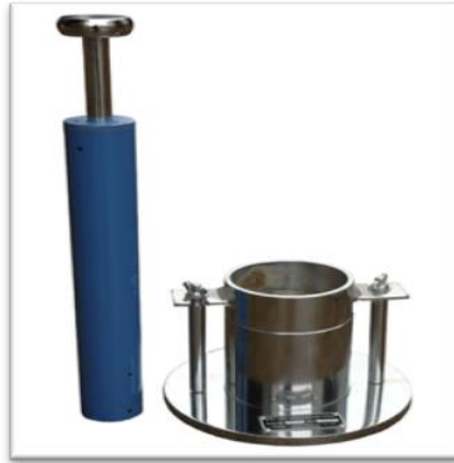
Figure IV.6 : Appareillage de l'essai de Proctor
