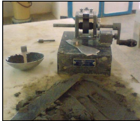
Figure IV.3 : Appareillage spécifique pour les limites de liquidités
