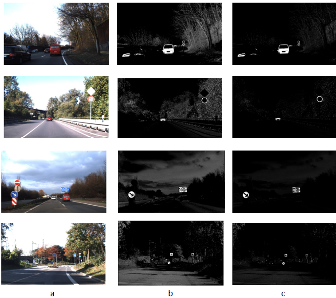
FIGURE 3.10 – Comparaison des images segmentées (a) image RGB, (b) méthode de lim et al [8], (c) notre méthode proposée.
