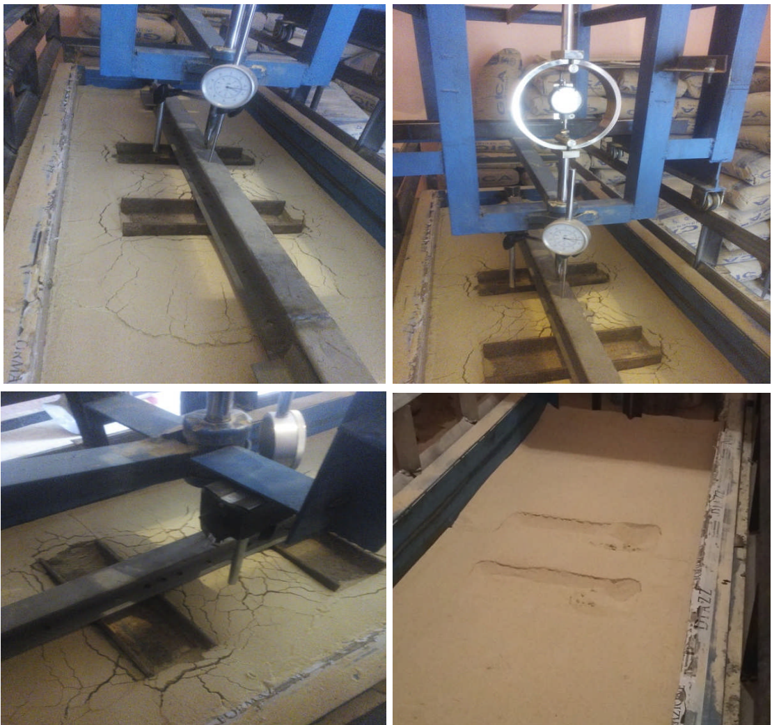
Figure 3.9 Photos des semelles au moment de rupture.
