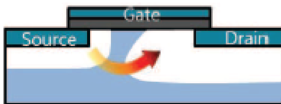
Figure 1.3 : Schéma de punch-through (à gauche) et Caractéristiques sous-seuil calculé V_{DS} = 2V , V_{SB} = 0V (à droite) [9].
