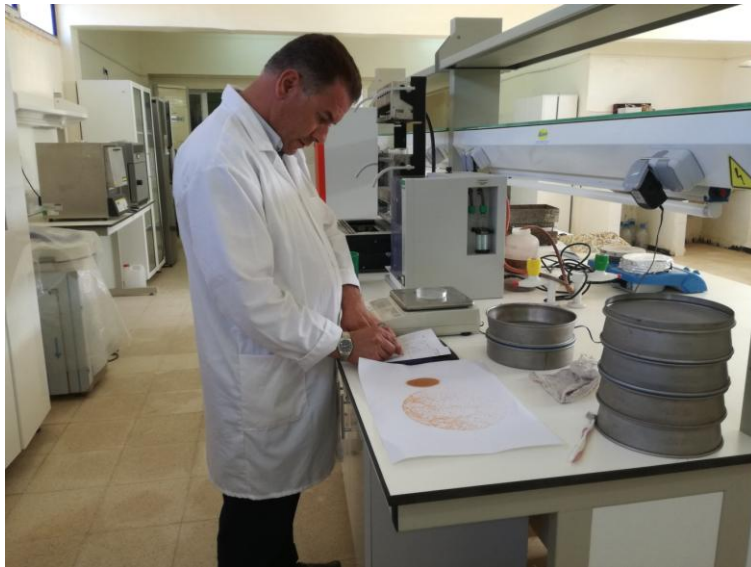
Figure 25. Dépouillement des résultats de l'analyse granulométrique au laboratoire
