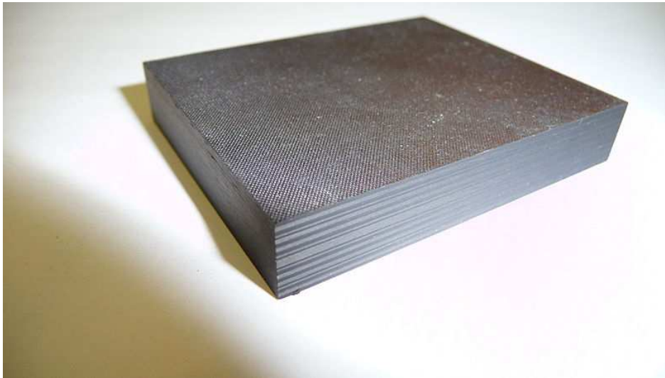
Figure 1.1 Un petit échantillon d'un stratifié Carbone/Epoxyde (domaine de l'aérospatiale)
