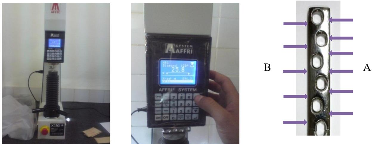
**Figure III.5** Duromètre digital (OMAGAFFRI modèle 250MRS) et les faces latérales
