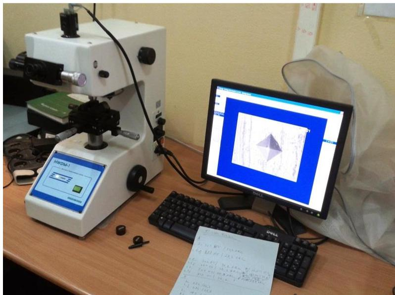
**Figure III.6** Microduromètre tester HWDM -1 High wood.
