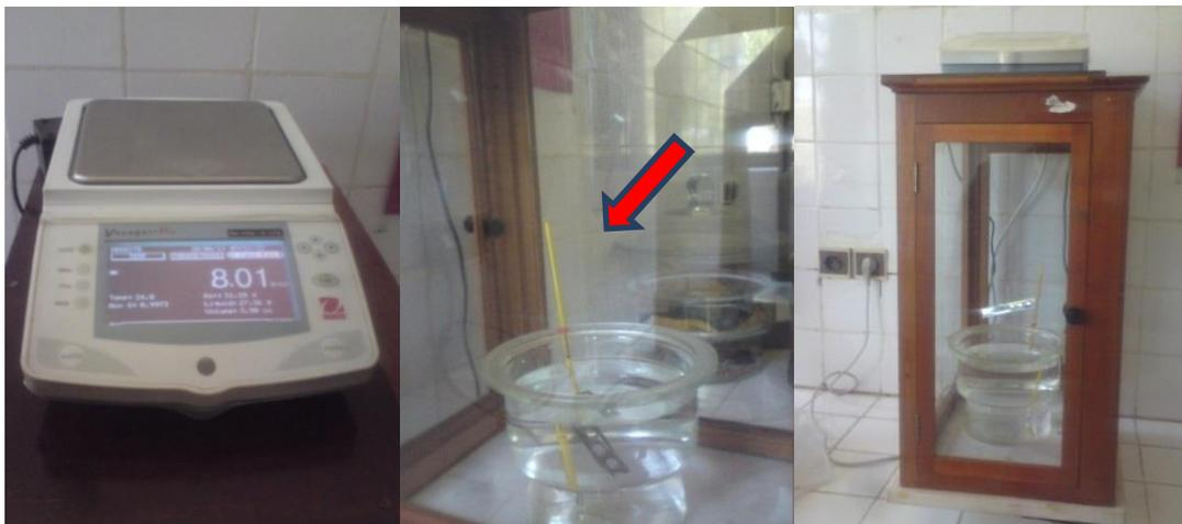
**Figure III.4** Densimètre digital (Voyager Pro; VP6102 C)
