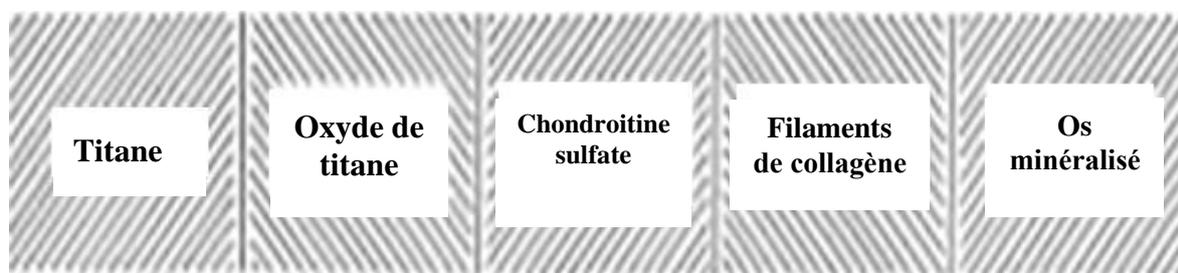
**Figure II.5** Interfaces os-titane (d'après Fallschussel, 1986) [1].
