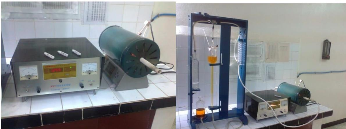
**Figure III.12** Carbomètre à four tubulaire.
