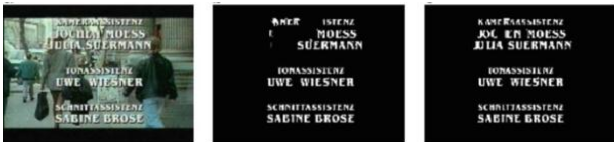
Fig. 3.3. Exemple de l'amélioration qu'apporte l'analyse du mouvement pour la détection du texte : (a) l'image originale, (b) Extraction, (c) Amélioration apportée par l'exploitation de la redondance d'informations sur les trames consécutives [61].
