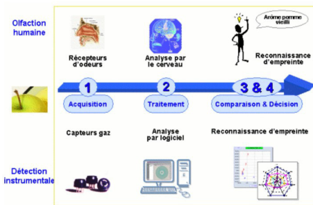
Figure I. 2. Analogie système olfactif humain-système électronique [26]
