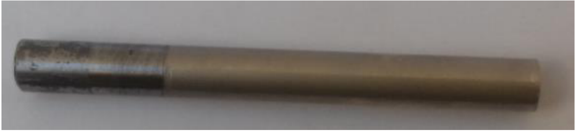
Figure II.9 Eprouvette revêtue en Ni/Al 2 O 3
