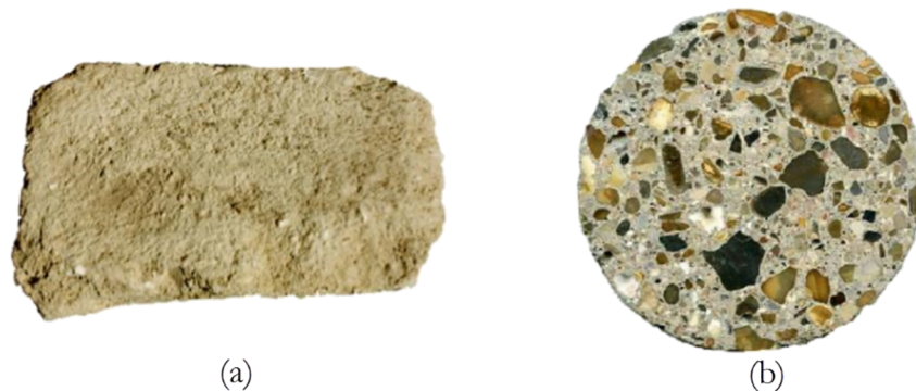
FIGURE 1.4. Matériaux de génie civil : (a) roche et (b) béton, Escoda (2012).
