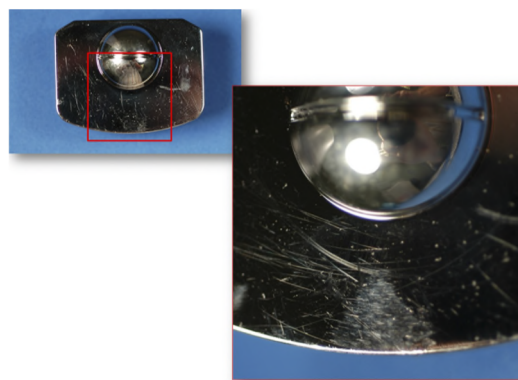
Figure II-5: Micrographie des plateaux supérieur (à gauche) et inférieur (à droite) d'une prothèse Maverick récupéré par (1,5 an vivo) montrant des rayures et une zone d'impact [36].
