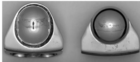
Figure II-11: Micrographie des plateaux supérieur (à gauche) et inférieur (à droite) d'une prothèse Prestige récupéré par (2,3 ans in vivo) montrant une cicatrice d'usure typique [36]
