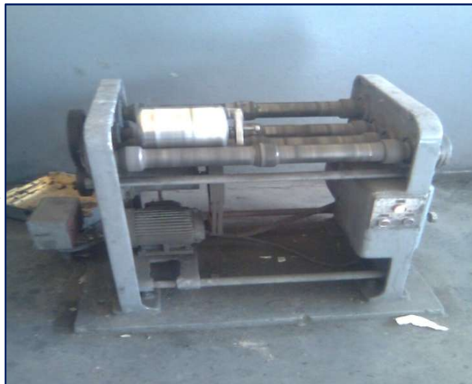
Figure III. 3 : Système de broyage sec à bille
