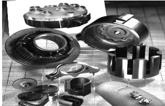
Figure II. 10 : Composants réalisés par compactage à froid et frittage
