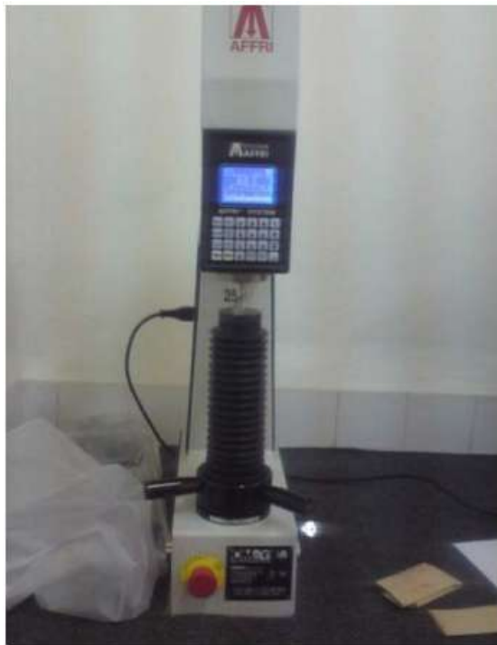
Figure III. 17 : Duromètre digital (OMAGAFFRI modèle 250 MRS)
