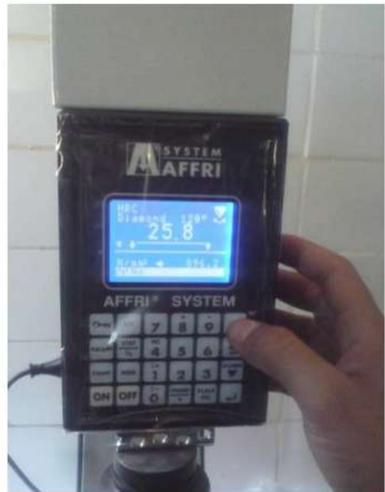
Figure III. 17 : Duromètre digital (OMAGAFFRI modèle 250 MRS)
