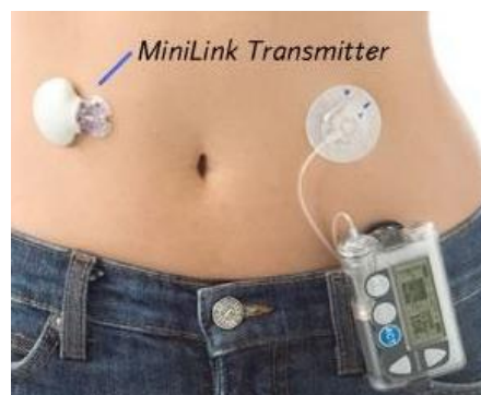
Figure 1. 26: Photo d'une pompe à insuline combinée à un capteur continu de glucose [80].
