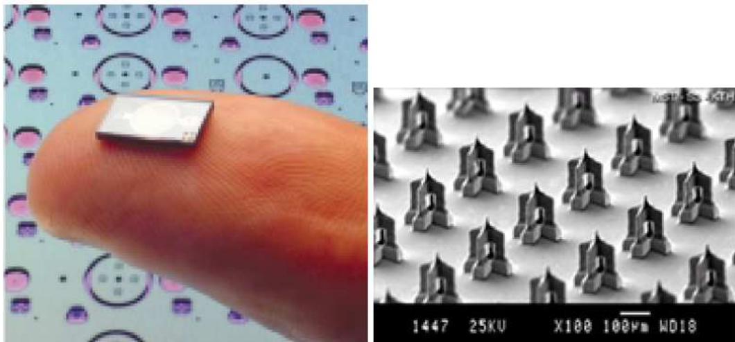
Figure I.2 : Dispositif implantable basé sur les MEMS (gauche) Micropompe développée par Debiotech SA pour l'insuline, injectant 150 nL par cycle; Le système est patché sur la peau du patient (À droite) Image SEM des aiguilles MEMS intégrées pour l'injection [32].
