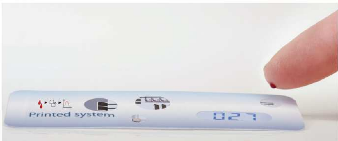
Figure I.1: Exemple d'un POC quantitatif donnant une concentration de glucose à partir d'une goutte de sang via un capteur ampérométrique [31].
