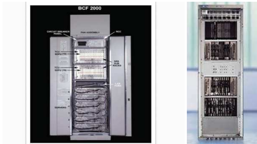
Figure I.7 : Exemple de Contrôleur de station de base.
