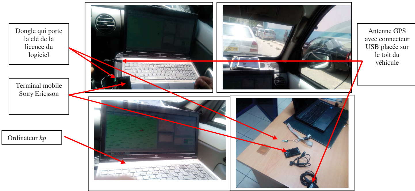
Figure IV.5: Kit des équipements utilisés pour les mesures.
