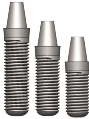
Figure 3.7 : Implants avec différentes longueurs ( D = 4,8 \text{ mm} ; L = 9 - 12 - 15 \text{ mm} ).
