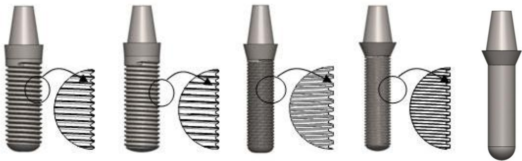
Figure 3.8 : Formes de filetages considérées (métrique, carrée, ronde et trapézoïdale) et implant lisse.
