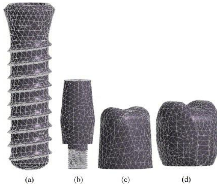
Figure 2.3 : Modélisation et maillage des éléments de la prothèse : (a) implant, (b) pilier, (c) armature (d) surface occlusale [59].
