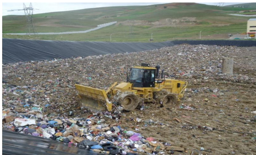
Figure I.11. Un compacteur du CET de la ville de Batna.
